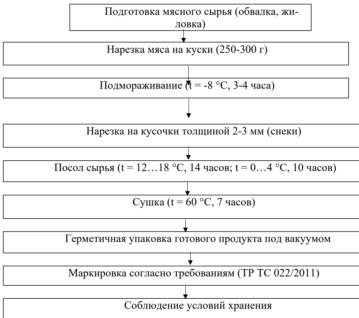
Рисунок 1 – Технологическая схема производства мясных снеков
